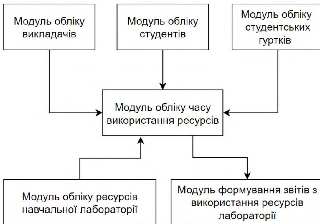
Рис. 2. Структурна схема автоматизованої системи управління ресурсами навчальної лабораторії
